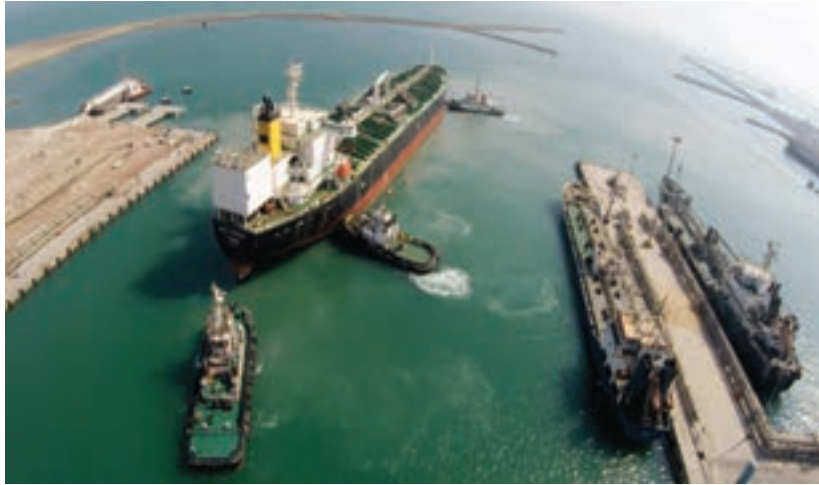
شکل ۲۰- عملیات پهلو دهی کشتی به اسکله
