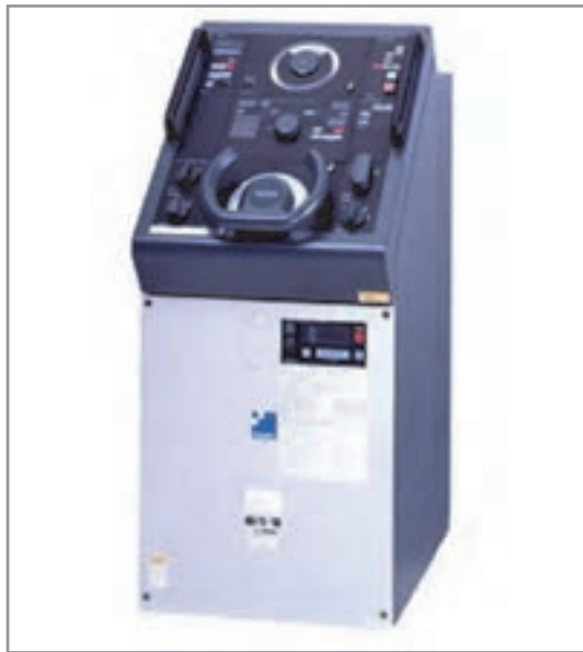
شکل ۲۶- سامانه هدایت خودکار در کشتی‌ها
