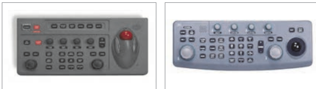
شکل ۱۴- دو نمونه از کلیدهای کنترلی صفحه نشان دهنده رادار
